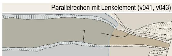
**Abb. 2** Skizzen der untersuchten Varianten von Schwemmholzrückhaltesystemen eingeteilt nach ihrer Position bezüglich des Auengebiets (blaue Fläche). Die Variante Parallelrechen mit Lenkelement stellt die Bestvariante dar. Die Fließrichtung ist in allen Teilabbildungen von links nach rechts.
