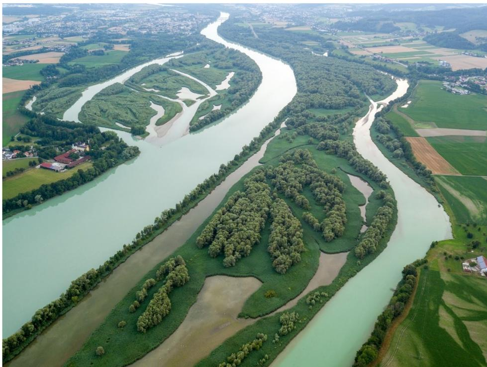
**Abb. 1** Blick über den mittleren Bereich des Stauraums Ering-Frauenstein mit der Heizinger Bucht rechts (Deutschland) und der Hagenauer Bucht im Hintergrund links (Österreich). Beide Buchten sind durch bewaldete Leitdämme vom Flussschlauch getrennt. Am Horizont flussauf die Städte Braunau und Simbach. Foto: Ingo Zahlheimer
