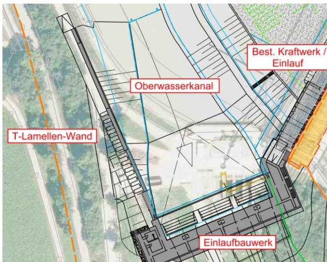
**Abb. 8** Lageplan Einlaufbereich KW Töging mit T-Lamellen-Schlitzwand
