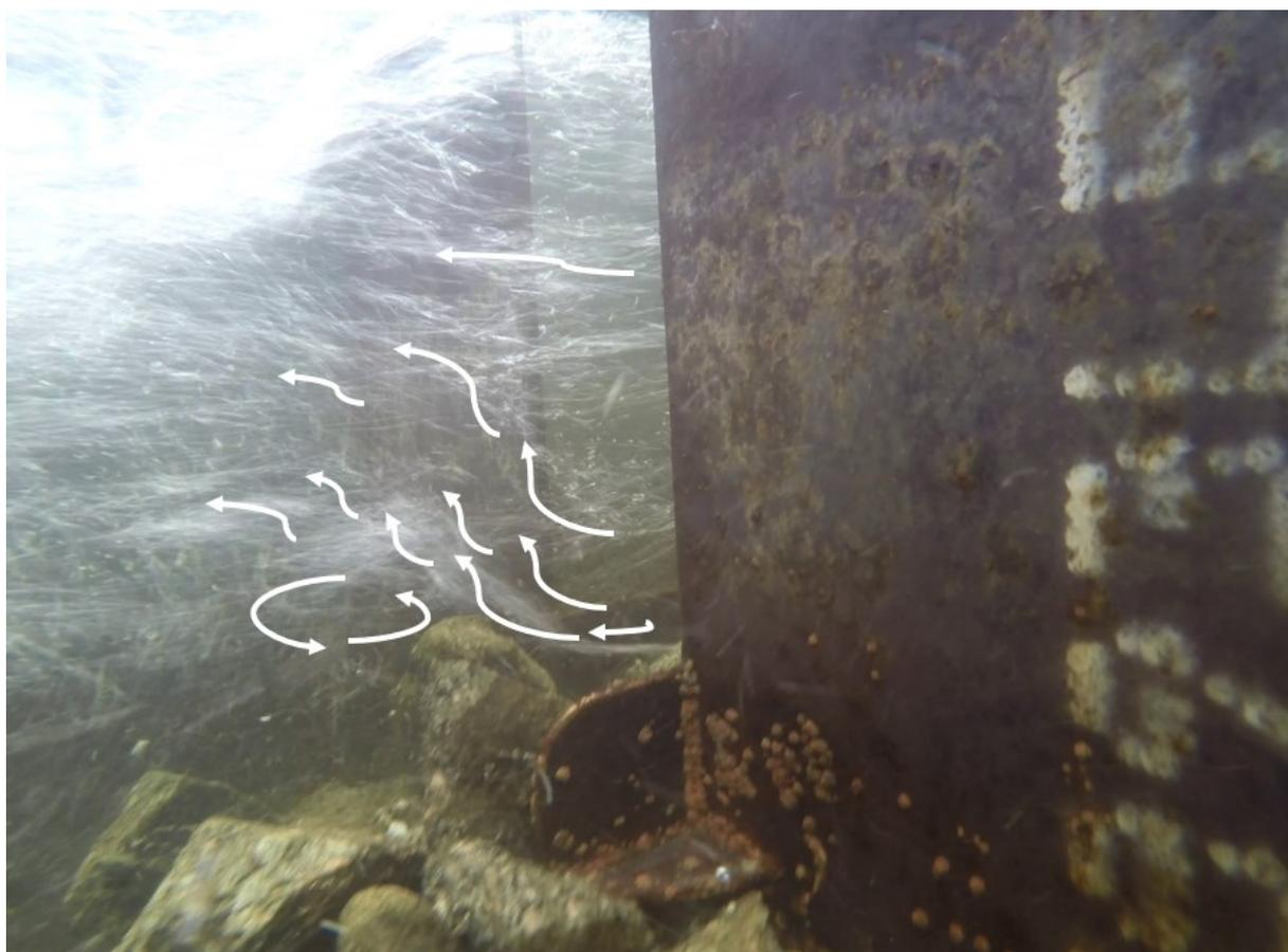
**Abb. 7** Turbulenzen durch Störsteinanordnung
