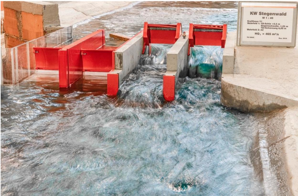
**Abb. 2** Tosbeckenoptimierung, Ansicht der Wehranlage vom Unterwasser: Rechts das Wehrfeld 1 mit der Variante 3, links das Wehrfeld 2 mit der Geometrie des Ausgangszustands. Hochwasserabfluss  $HQ_1(n-2)$ . (Foto: Piki/TU Graz)
