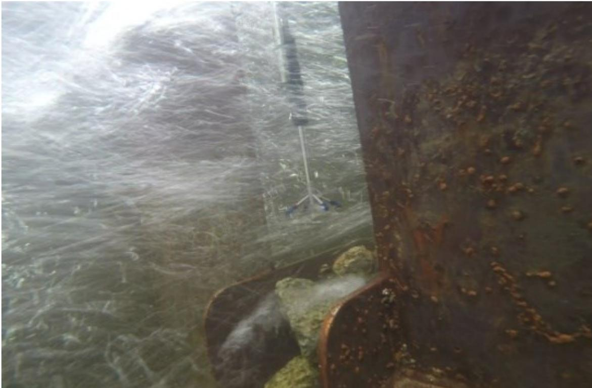
**Abb. 3** Messung mit Vectrino-Sonde in einer zentrierten Messlotrechten
