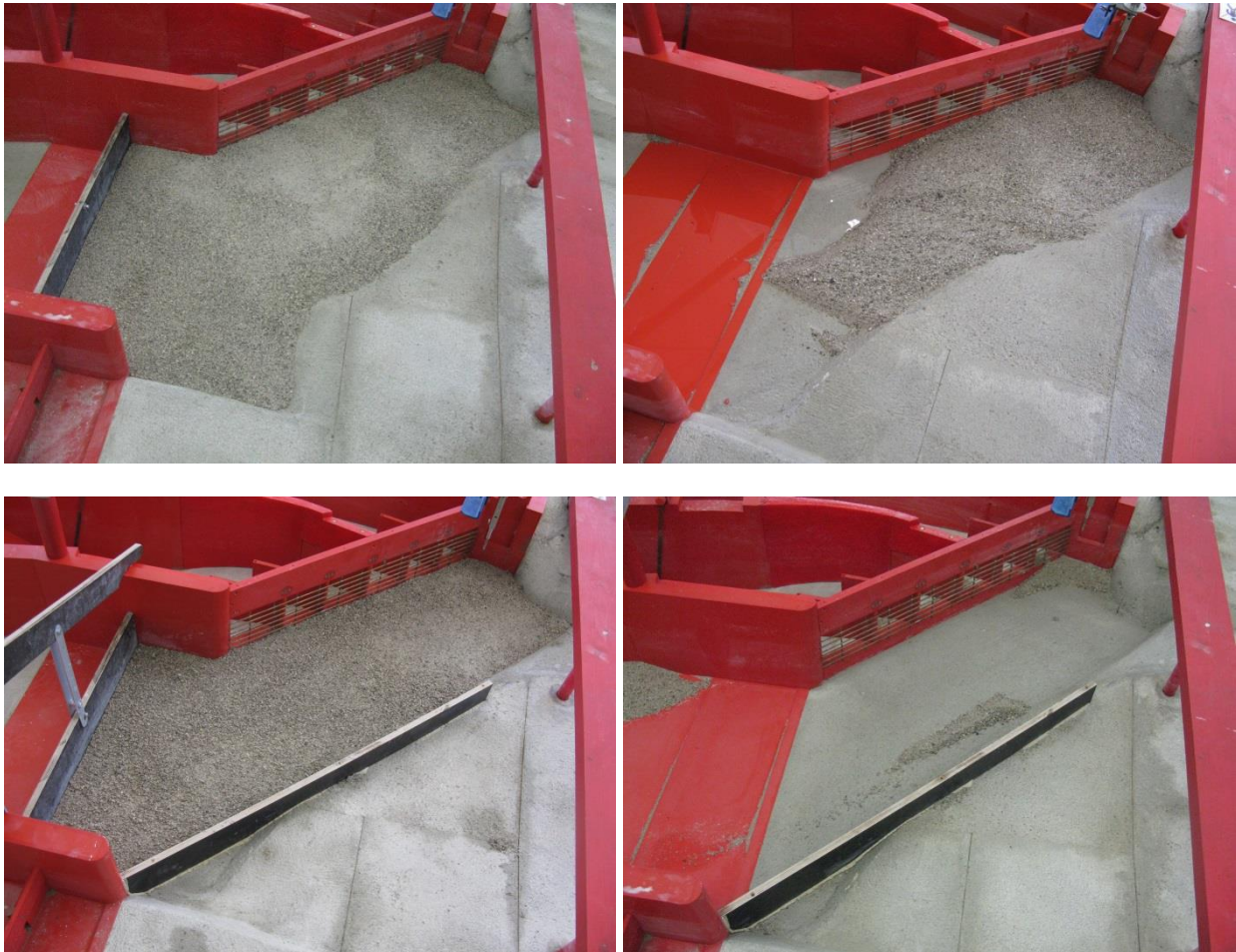
Abb. 7 Verlandung oberhalb des Kraftwerks vor (links) und nach der Spülung (rechts) für den Ausgangszustand der Planung (oben) und den optimierten Zustand mit Leitwand (unten)
