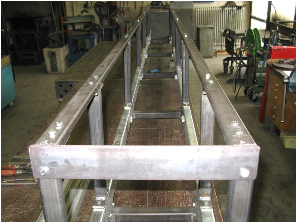
Abb. 4 Versuchsrinne ( B = 0,25 \text{ m} ) im Bauzustand
