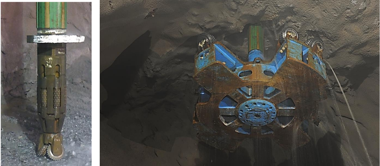
Abb. 6 Raise-Boring Verfahren, Bohrkopf Pilotbohrung (links), Aufweitungskopf an Bohrgestänge (rechts)
