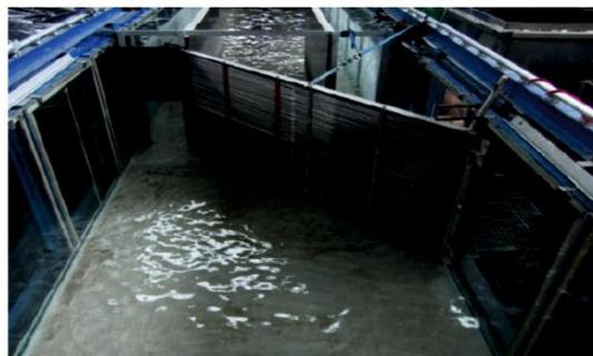
Ansicht des Setupkomplex „Schrägrechen“ in Fließrichtung gesehen. Montiert ist bei dieser Aufnahme die rechteckförmige Kontur ohne Kubatur und der Bypass zum Nebenkompartment ist verschlossen.
