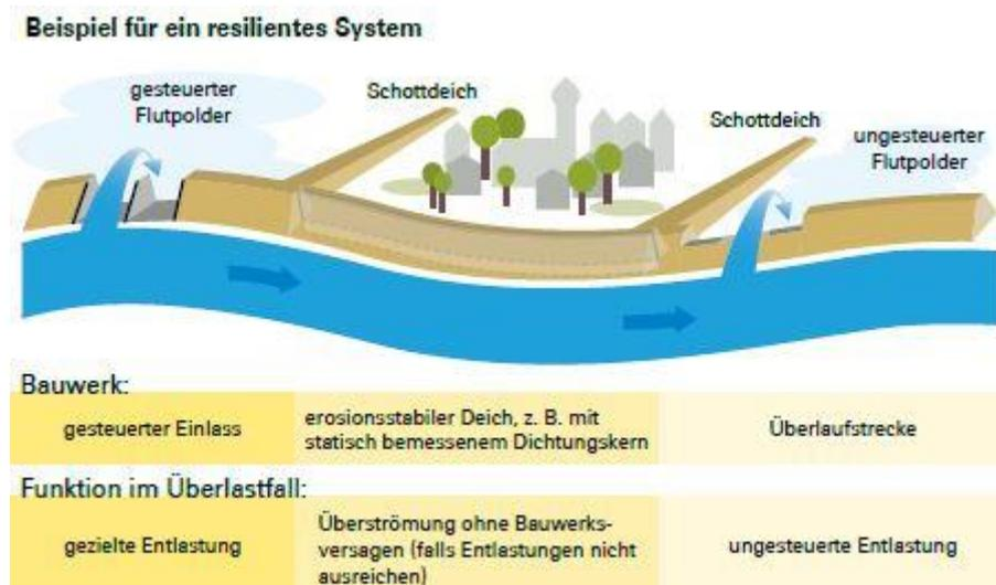
**Abb. 2** Darstellung eines resilienten Hochwasserschutzsystems
