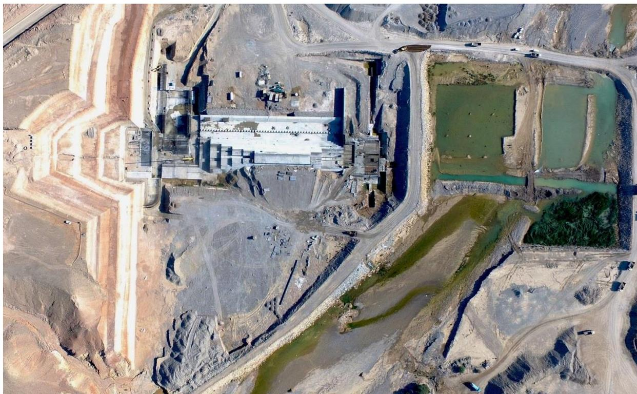
**Abb. 7** Luftbild der Baugrube (links) und der Kofferdämme nach einem Hochwasserereignis
