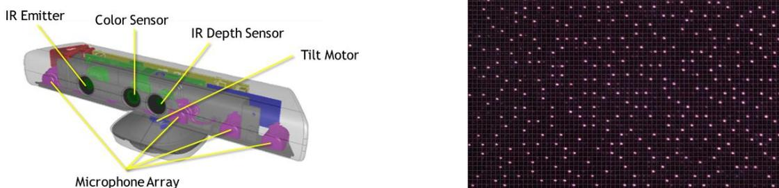
**Abb. 1** links: Der Kinect-Sensor mit seinen Bestandteilen (Microsoft); rechts: Beispiel eines projizierten Infrarotmusters (Reichinger 2011)
