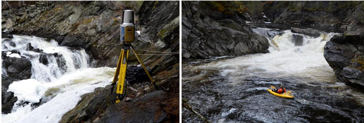
**Abb. 2** Messmethoden zur Erstellung des digitalen Geländemodells, links: terrestrischer 3D Laserscanner, rechts: GPS kombiniert mit Echolotmessung
