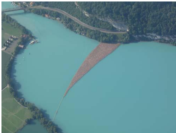
Abb. 7 Schwemmholzsperrern auf dem Brienzensee während des Hochwasserereignisses 2005 (Foto: Bundesamt für Umwelt, CH).
