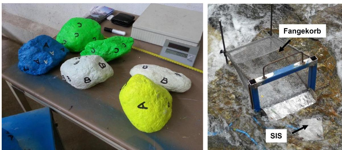
**Abb. 3** Farbracersteine (links) (Spreitzer, 2014) und Sediment Impact Sensor (SIS) auf einer Rampe im Schöttelbach mit Geschiebefangekorb
