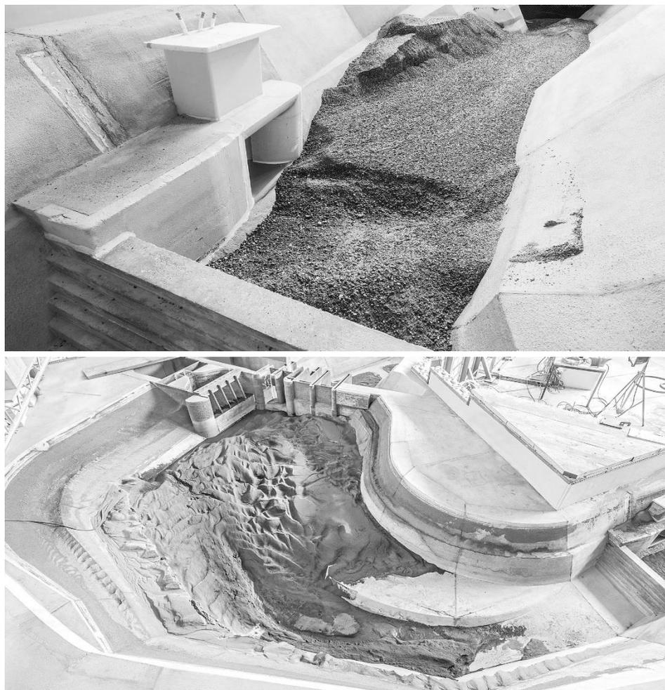
**Abb. 5** Verbleibende Verlandung nach der jährlichen Spülung mit  $Q = 150 - 200 \text{ m}^3/\text{s}$ . Oben: Spülung der Geschiebeablagerungen durch den Umleitstollen nach einem  $HQ_{350}$ . Unten: Spülung der Feinsedimente durch die Spüldurchlässe nach einem  $HQ_{20}$ , modelliert mit gemahlene Walnussschalen.
