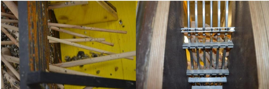
**Abb. 6** linkes Bild: Balkensperre mit massiver Verkläusung; rechtes Bild: Rückseite der Rechensperre; die Hölzer lagern sich direkt an den vertikalen Stäben an und treten nicht hindurch.
