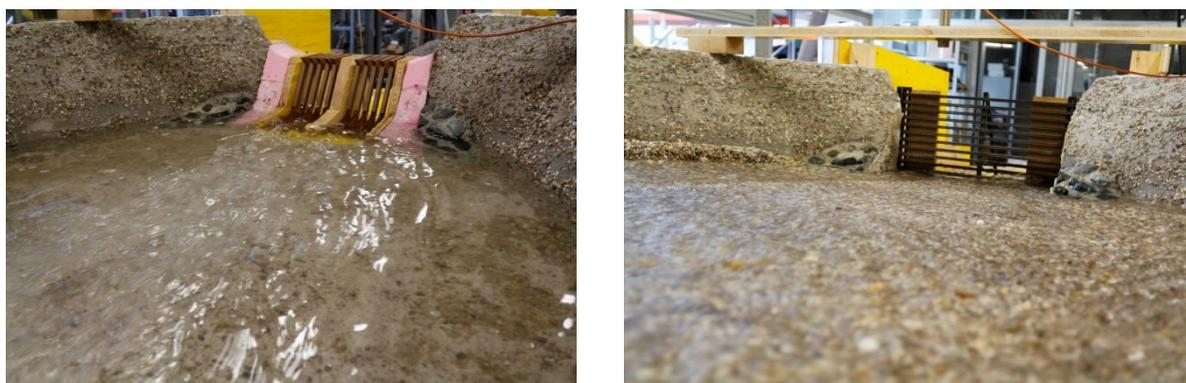
**Abb. 4** Rechensperre (links) und Balkensperre (rechts)
