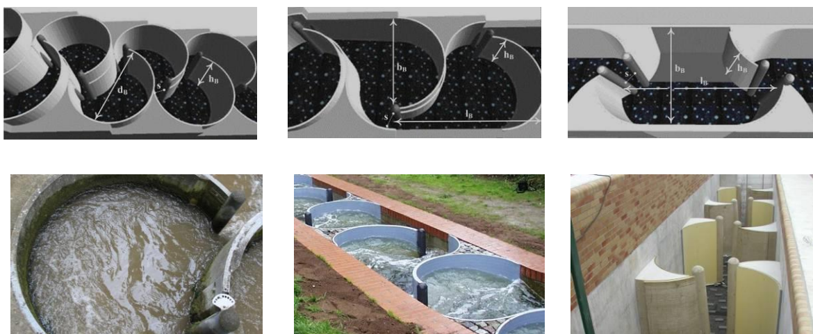
Abb. 1 Bauformen des Rundbeckenpasses, links: C-Typ, mittig: J-Typ, rechts: H-Typ
