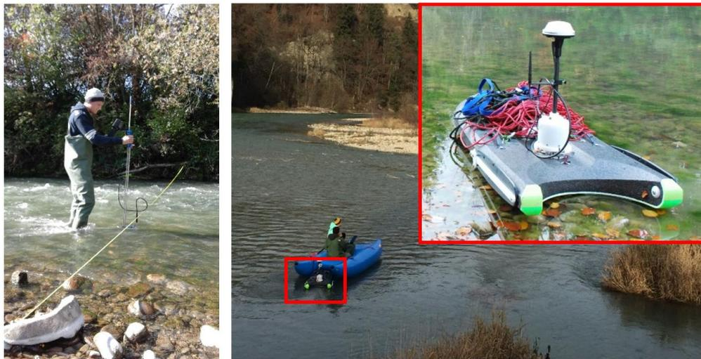
**Abb. 3** Die verwendeten Messgeräte. Links der SonTek Flowtracker®, rechts der SonTek Riversurveyor®.
