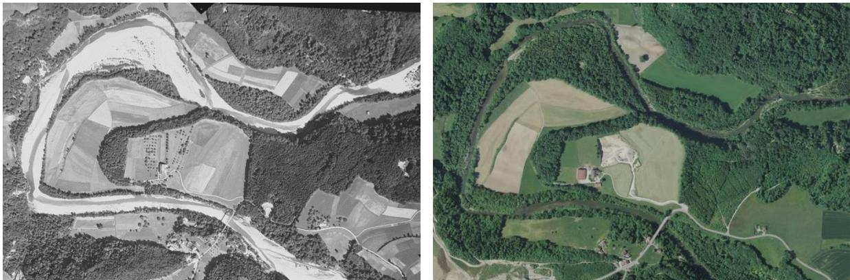
**Abb. 1** Mäander der Restwasserstrecke der Saane zwischen Rossens und Hauterive von 1943 (links) und 2012 (rechts). Die Konstruktion des Dammes in Rossens 1948 begünstigte die Ausbreitung der Vegetation. Fließrichtung von unten nach oben. Fotoquelle: [www.map.geo.admin.ch](http://www.map.geo.admin.ch) (swisstopo)
