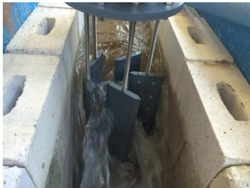
**Abb. 2** Testmodell des StECon mit Schaufelruderform 4.1 in der begrenzten Strömung
