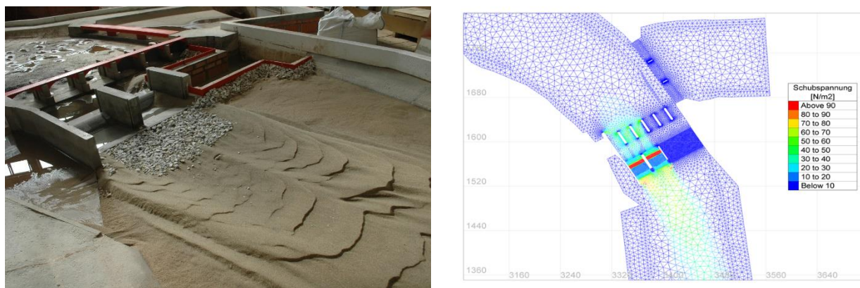
Abb. 6 Bauphase BA3b, HQ 100 Winter , Kolkbildung (links) und Sohlschubspannungen (rechts)
