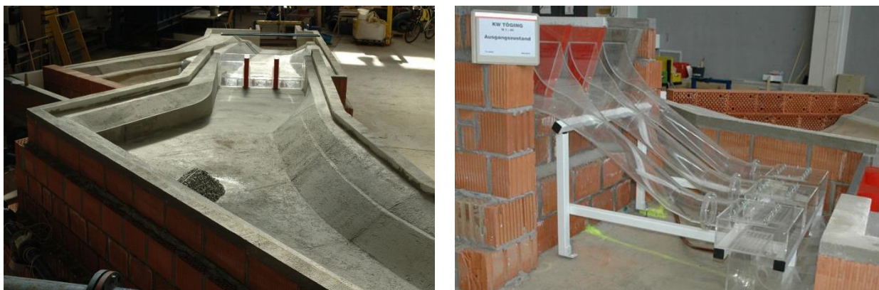
Abb. 2 Vollmodell Kraftwerk Töging im Wasserbaulabor der TU Graz, M 1:40, Ausgangszustand
