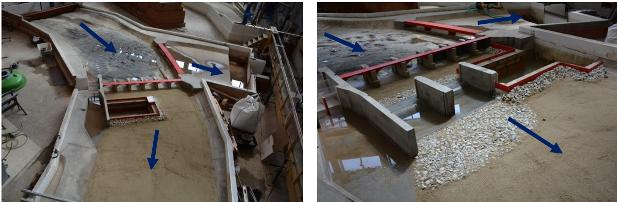
Abb. 4 Vollmodell Wehr Jettenbach im Wasserbaulabor der TU Graz mit alter Wehranlage und Bauabschnitt BA2 (links) und BA3b (Baugrube orographisch links und 2 fertiggestellte Wehrfelder) mit Nachkolsicherung durch Wasserbausteine
