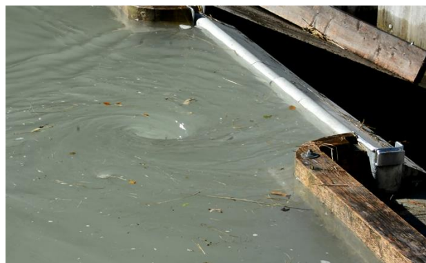
Abb. 5 Wirbelfreie Zuströmung (li.), leichte Wirbelbildung ohne Überfallströmung
