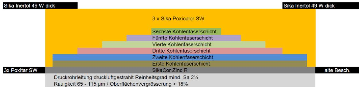
**Abb. 6** Aufbau der 6 Lagen S&P C-Sheet 640
