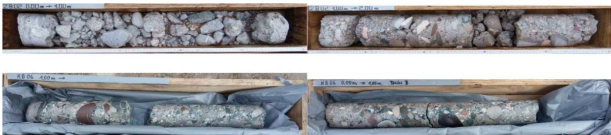
Abb. 7 Bohrkern vor (oben) und nach den Injektionen (unten) (Quelle: SBI, EDR)
