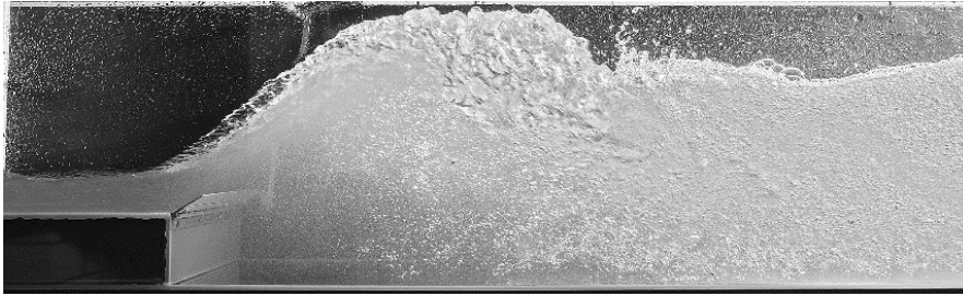
Abb. 5 Maximale Wellenhöhe im physikalischen Modell bei Q = 40 l/s, F_o = 4.0 , k = 5.0 cm und \kappa = 30^\circ
