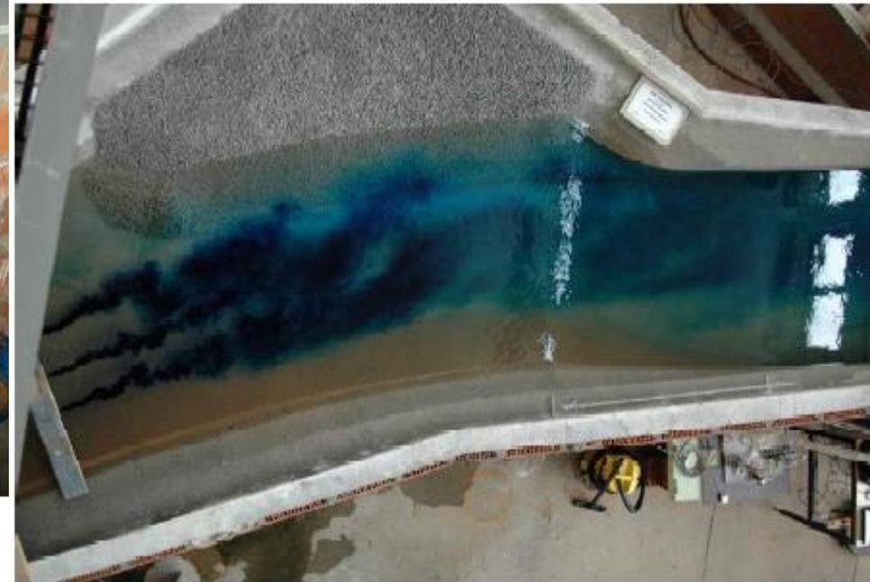
Anhang 29: Ausführungsvorschlag Zulauf neues Kraftwerk Töging, Dokumentation Strömung –  $Q_{\text{B}}=410\text{m}^3/\text{s}$ , 3-Maschinenbetrieb, Buhne bis Turbineneinlauf – 2.
