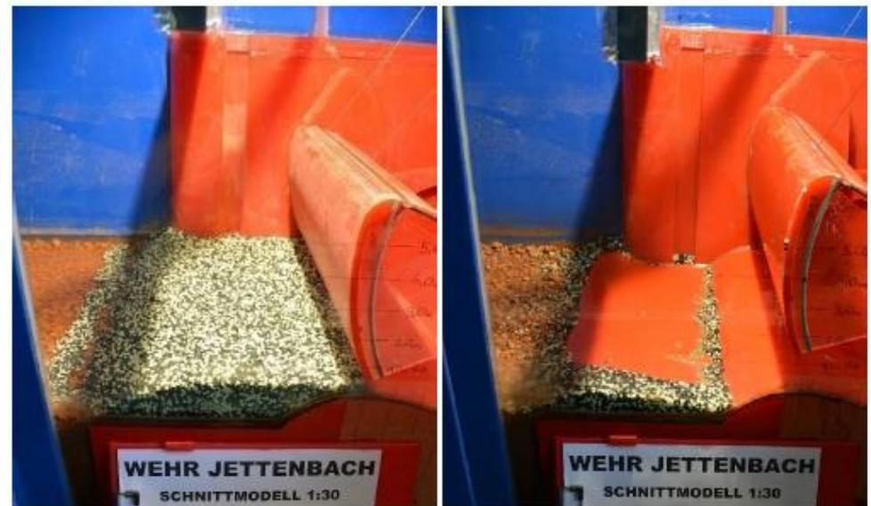
Abbildung 34: Spülversuch mit eingebauter Veränderung vor dem Wehrhörer (links), Ergebnis nach Ende des Spülversuchs (rechts)
