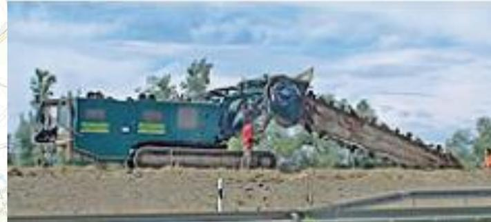
FMI (Fräs-Misch-Injektion) Gerät: Foto Fa. Sidla & Schönberger
